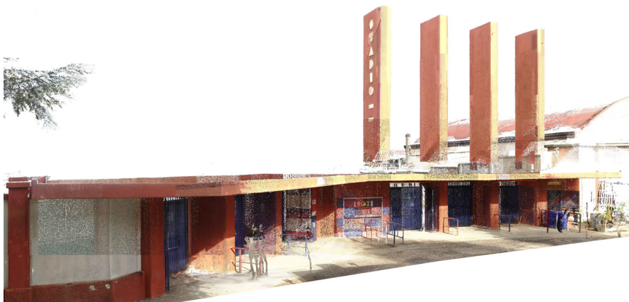
Fig. 19: Rilievo della pensilina di accesso alle tribune secondarie: nuvola di punti.
