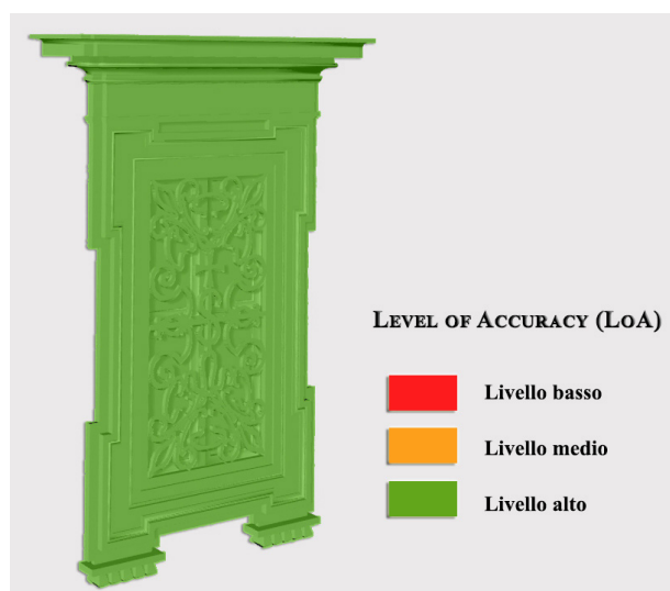
Fig. 20. Level of Accuracy (LoA) del modello di una finestra del monastero di San Basilio: LoA alto, cioè 70% del modello ha una deviazione inferiore a 20 mm, e il 30% con una deviazione inferiore a 50 mm.
