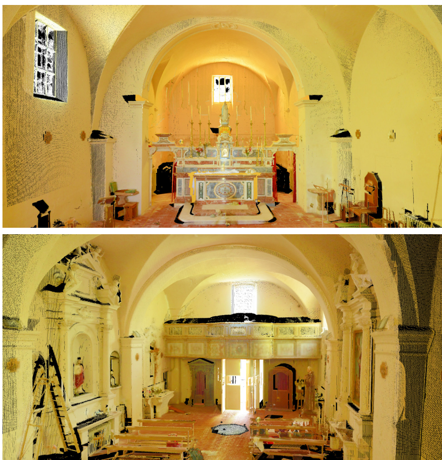
Fig.4 Chiesa di San Nicola (XIII secolo) ad Arischia (L'Aquila): nuvole di punti acquisite con laser scanner Leica HDS 6200, a cui è stato associato il valore di colore RGB ottenuto tramite panorami sferici.
