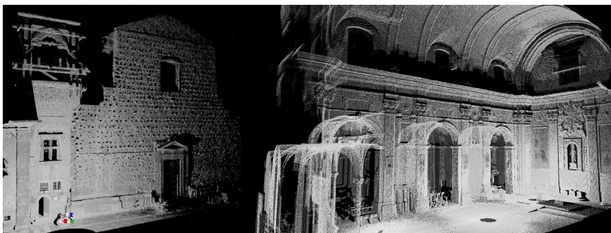
Fig. 23. Rilievo digitale della chiesa di Santa Margherita (L'Aquila): nuvola di punti della facciata e dell'aula.
