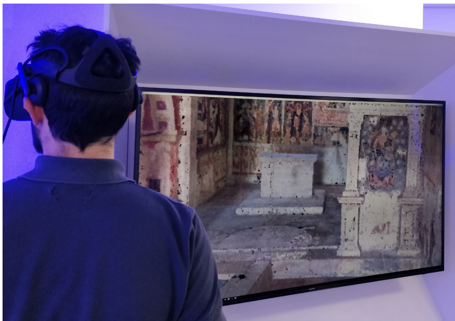
Fig. 5. Visita virtuale della chiesa di Santa Maria ad Cryptas, Fossa (L'Aquila), XIII sec.: navigazione della nuvola di punti, attraverso il software Scene e un visore per Realtà Virtuale.
