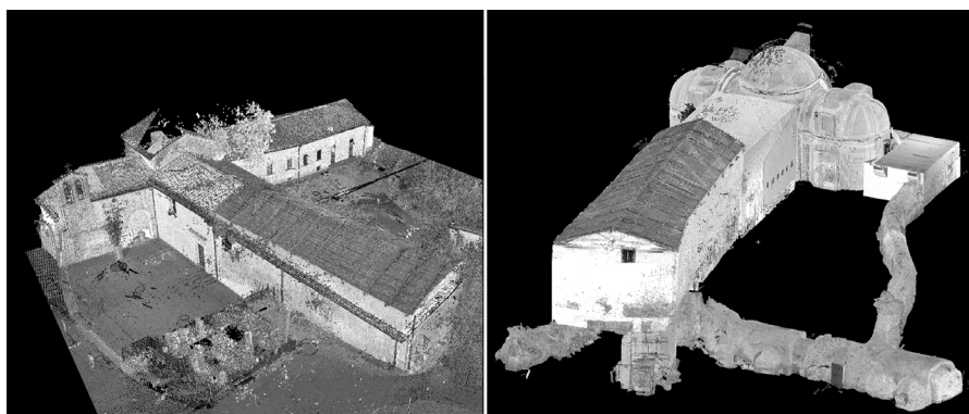
Fig.1 Viste della nuvola di punti del complesso architettonico di San Michele Arcangelo (San Vittorino, L'Aquila), acquisite con laser scanner Leica HDS 6200.
