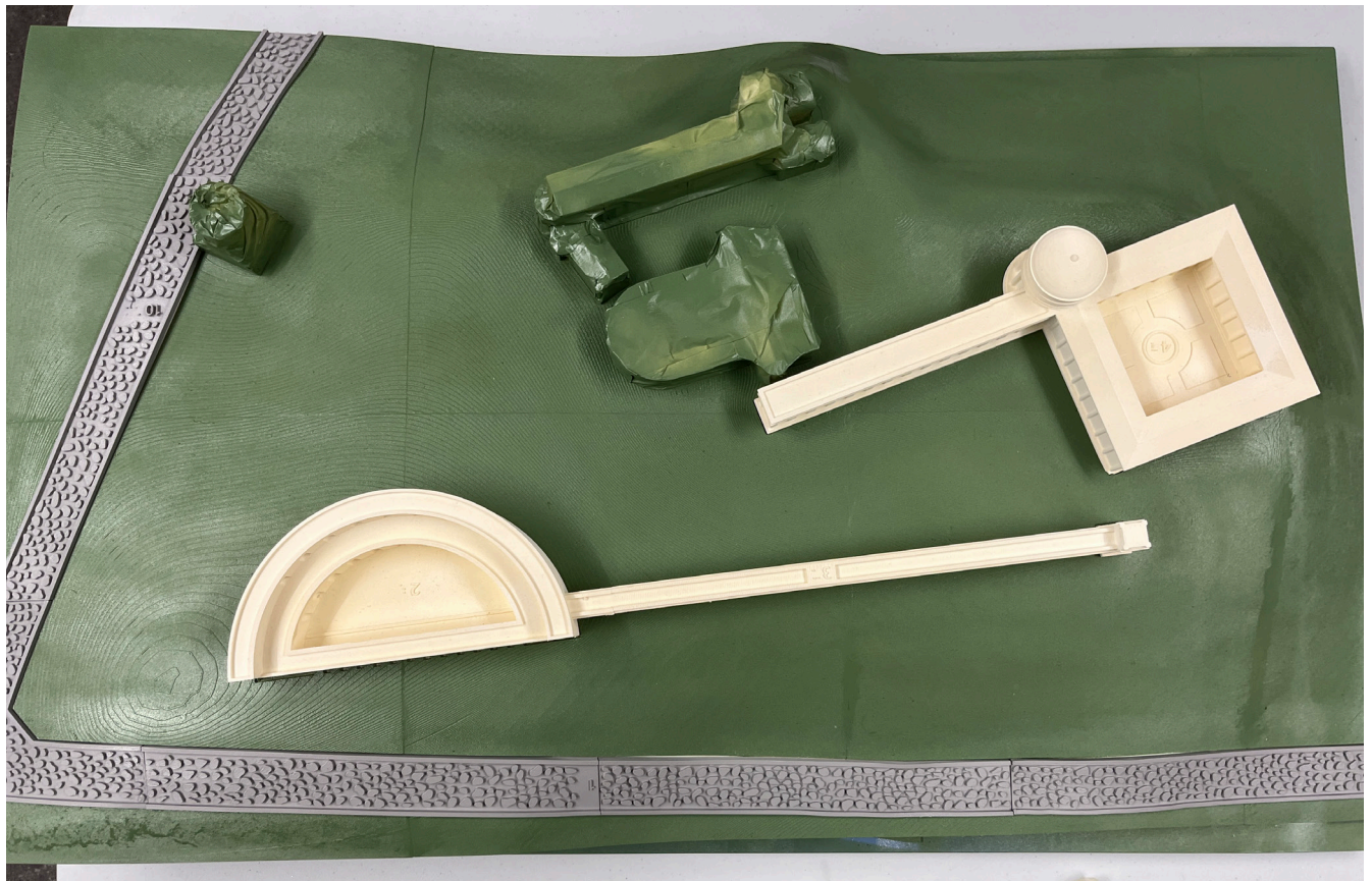
Fig.6: Vista della modellazione degli edifici nella quale si possono notare gli identificativi in nero e braille (elaborazione dell'autore).
