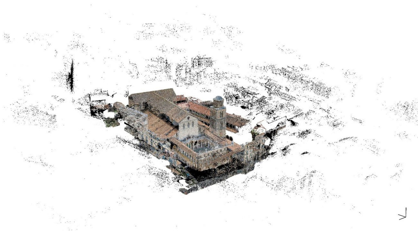
Fig. 3: Resultados del Proceso fotogramétrico realizado en el Caso n°3 – Catedral de Salerno; relevamiento realizado como objeto de estudio del Curso de Rilievo del año académico 2023/2024-UNISA (Salerno-Italia), Año 2024. Autor: REYES, Juan Cruz
