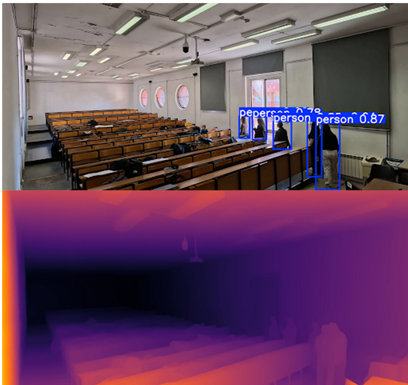
Fig. 4: Acquisizione video e prima fase di riconoscimento delle persone (in alto). Applicazione dell'algoritmo per la definizione delle coordinate dimensionali (in basso).
