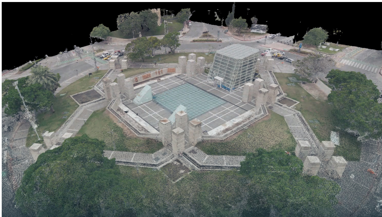
Fig. 4: Enriquecimiento del modelo BIM con información sobre la implantación de la obra en el entorno a partir del relevamiento aerofotogramétrico.
