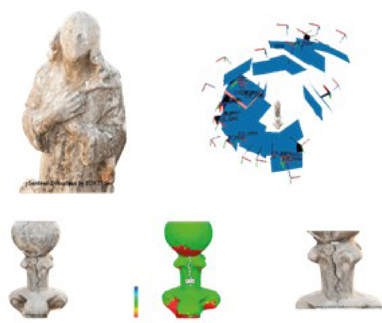
Fig. 1: Resultados del Proceso fotogramétrico realizado en el Caso n°1 – Iglesia del Sagrado Corazón de Jesús, Los Capuchinos (Córdoba-Argentina), Año 2022. Autor: REYES, Juan Cruz
